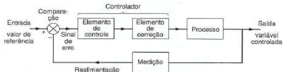
Figura 2-6 - Diagrama que mostra um sistema de controle do tipo malha fechada.
